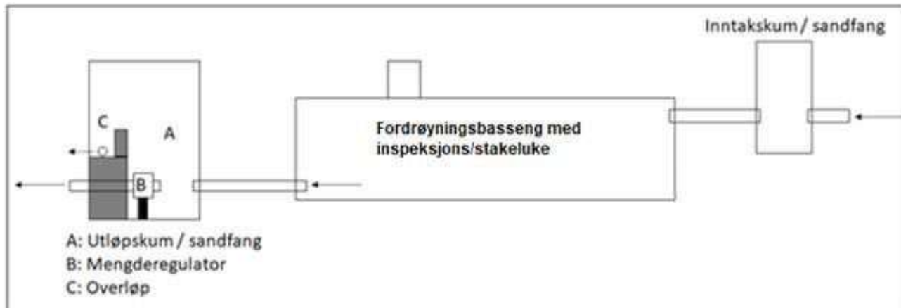
Figur 11. Prinsippskisse for fordrøyningsbasseng. (kilde: Oslo VAV)
