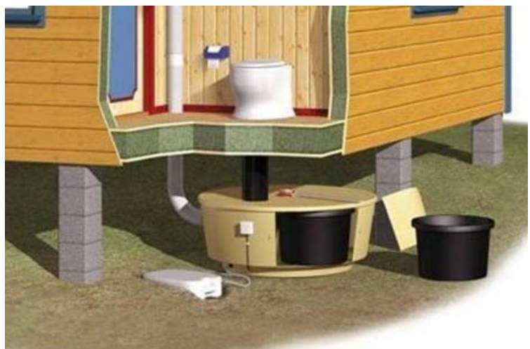
Eksempel på biologisk toalett "snurredass" (kilde: www.avlop.no ).
