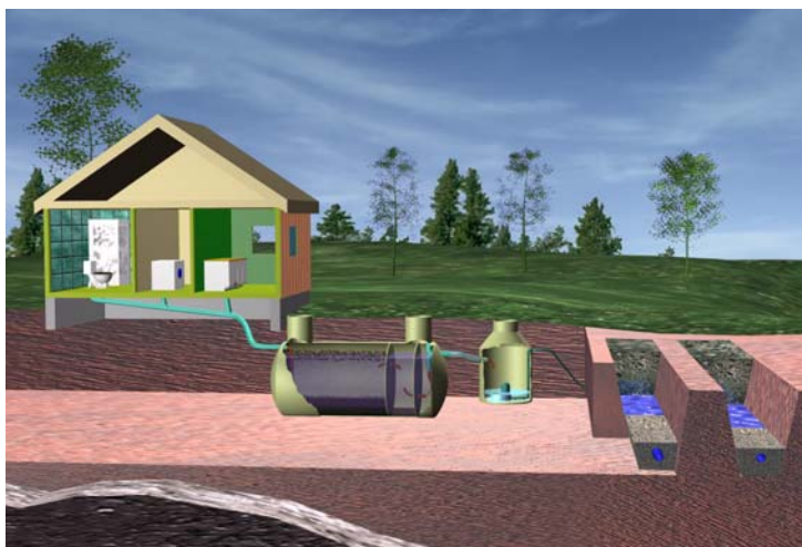
Skisse av lukket infiltrasjonsanlegg (kilde: www.avlop.no ).
