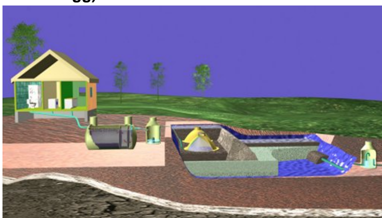
Skisse av våtmarksfilter med forfilter (kilde: www.avlop.no ).
