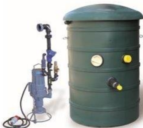
Eksempel på en pre-isolert pumpekum for trykkavløp. Mål 0,8 m diameter og 1,4 m høy.
