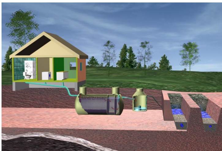
Skisse av lukket infiltrasjonsanlegg (kilde: www.avlop.no ).
