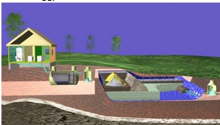
Skisse av våtmarksfilter med forfilter (kilde: www.avlop.no ).
